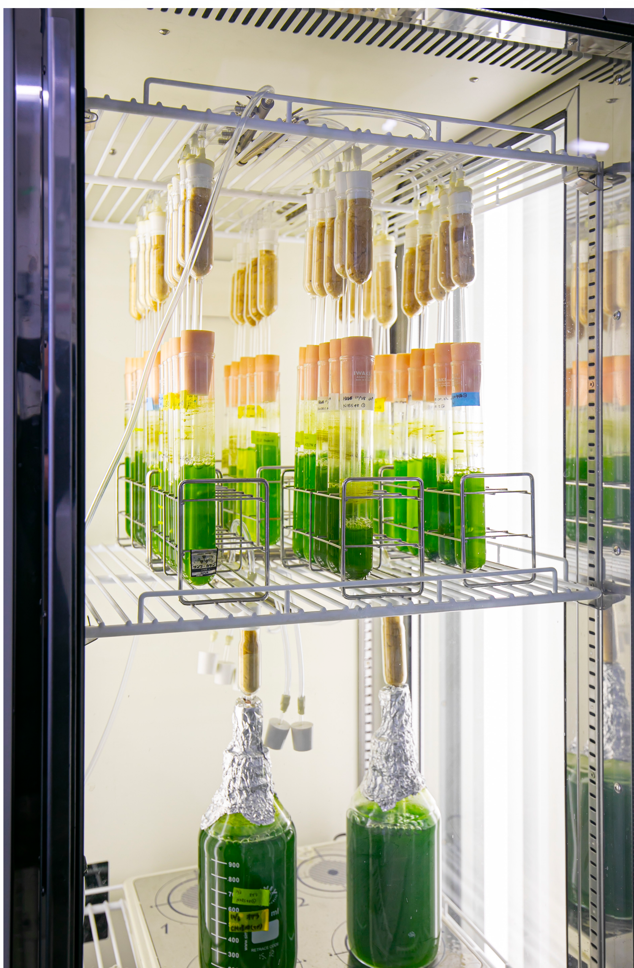
微細藻類の培養の様子。微細藻類は温度と光が制御されたインキュベーターという箱の中で、空気を吹き込みながら培養する。
